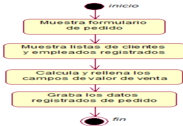
Figura 137: Diagrama de estado caso de uso del sistema graba datos de pedido
