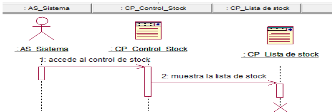
Figura 68: Diagrama de secuencia caso de uso del sistema muestra lista de productos de stock
