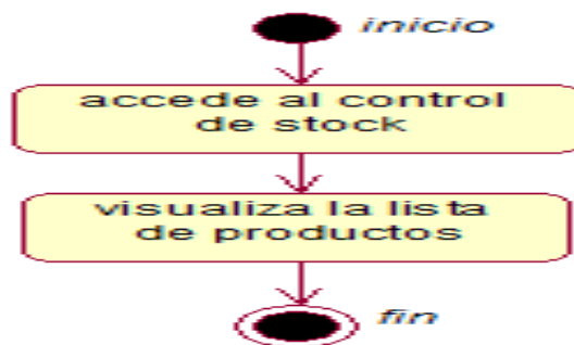
Figura 149: Diagrama de estado caso de uso del sistema muestra lista de productos de stock
