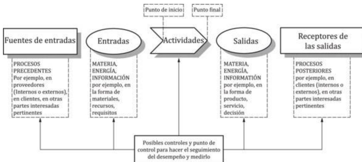
*Nota.* Se muestra la representación esquemática de un proceso y su interacción. Fuente. ISO 9001.
