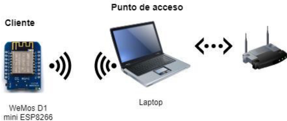
Figura 48. Esquema de conexión a un punto de acceso
