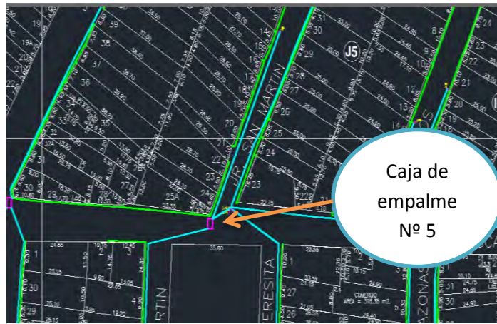
Figura N° 31: Caja de empalme N° 5
