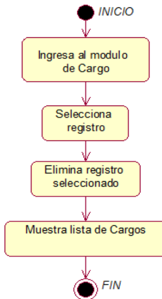
Figura 209. Diagrama de estado eliminar Cargo.
