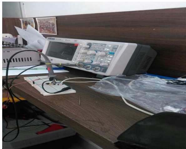
Figura 23: Foto - Elaboración del sensor de saturación en el tablero de pruebas
