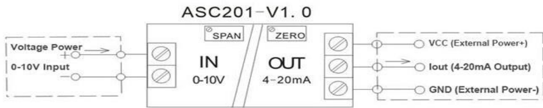
Figura 16. Módulo de acondicionamiento
