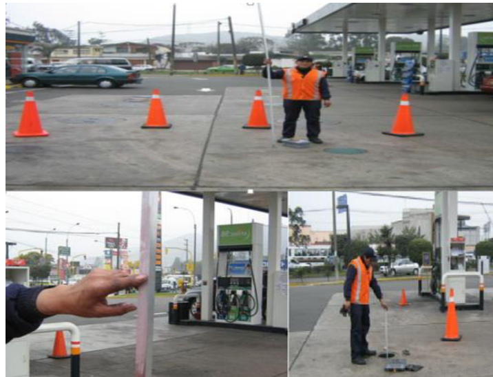
Figura 9: Medición de los pozos
