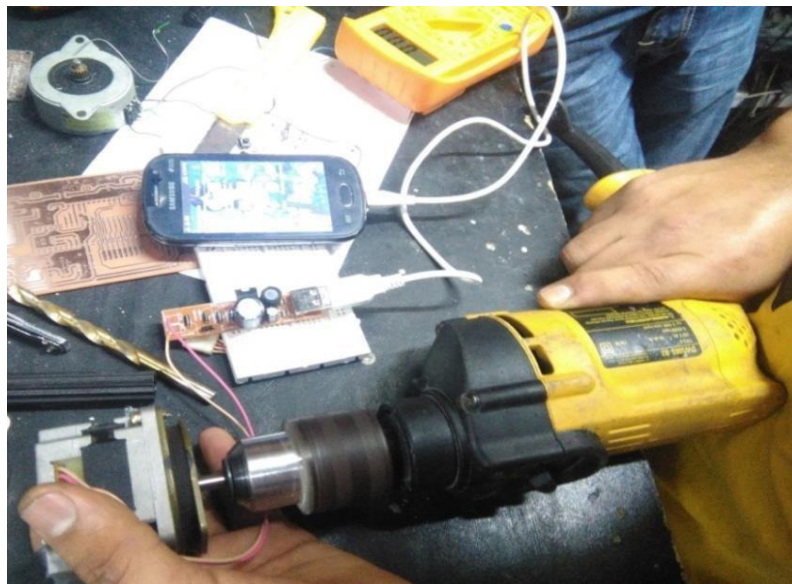
Figura 39: prueba con taladro graduado a unos 26000RPM para hacer pruebas con el motor paso a paso. (Elaboración propia)
