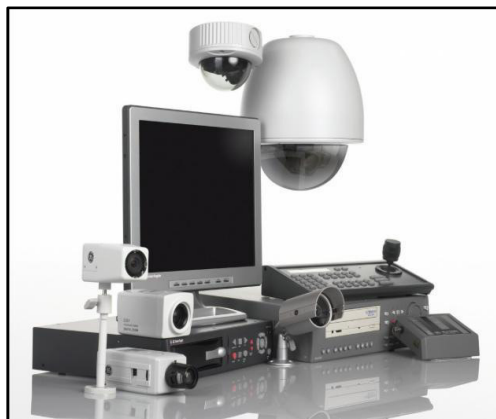
Figura N° 01: Equipos básicos de un sistema de seguridad
