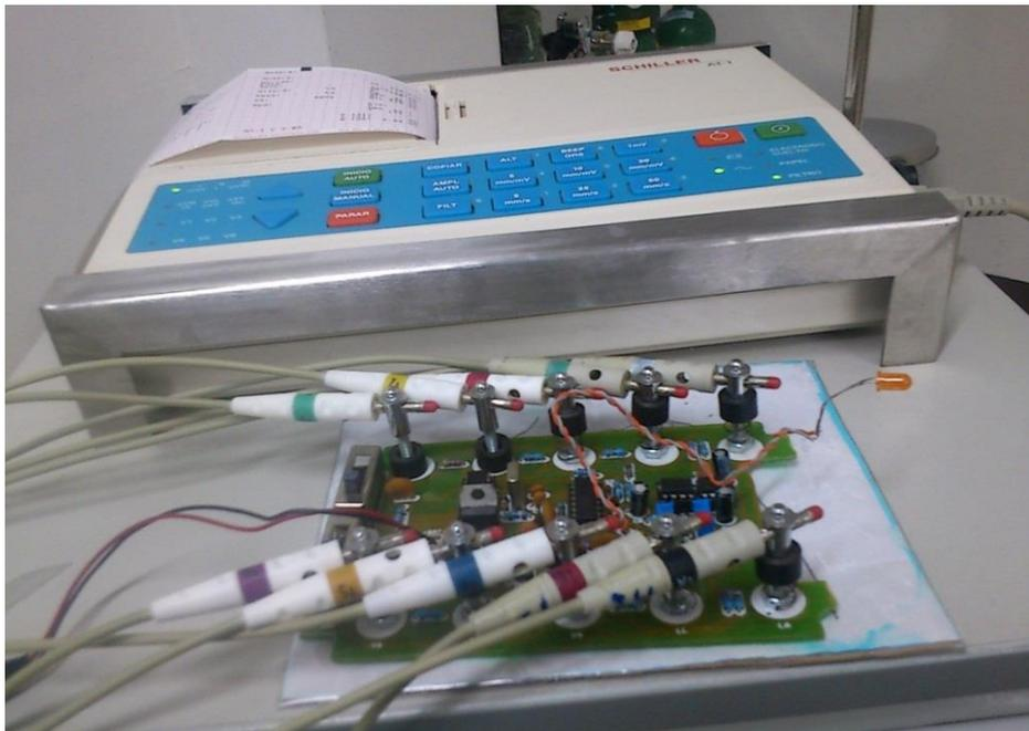
*Figura 32:* ejemplo de conexión del simulador con el Electrocardiógrafo At1 Schiller.
