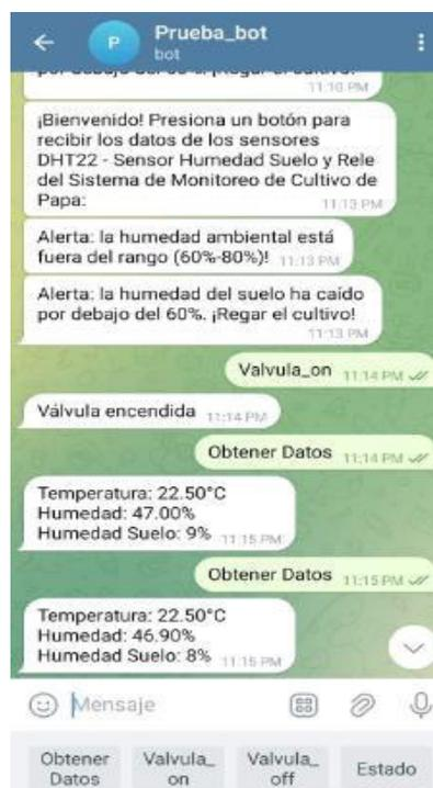
**Nota.** La figura muestra las notificaciones de alertas del sensor capacitivo (Humedad de Suelo), también presionando el botón de “**Obtener Datos**” se visualiza el estado de los sensores, el botón de “**Valvula\_on**” abre la válvula, el botón “**Valvula\_off**” cierra la válvula y el botón “**Estado**” informa el estado de la válvula.
