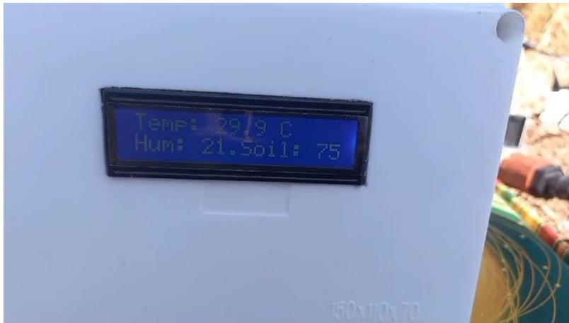
**Nota.** Se visualiza en el Display los valores de las mediciones como temperatura, humedad y humedad del suelo (Soil)
