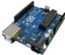
*Arduino UNO con microcontrolador en formato DIP*
