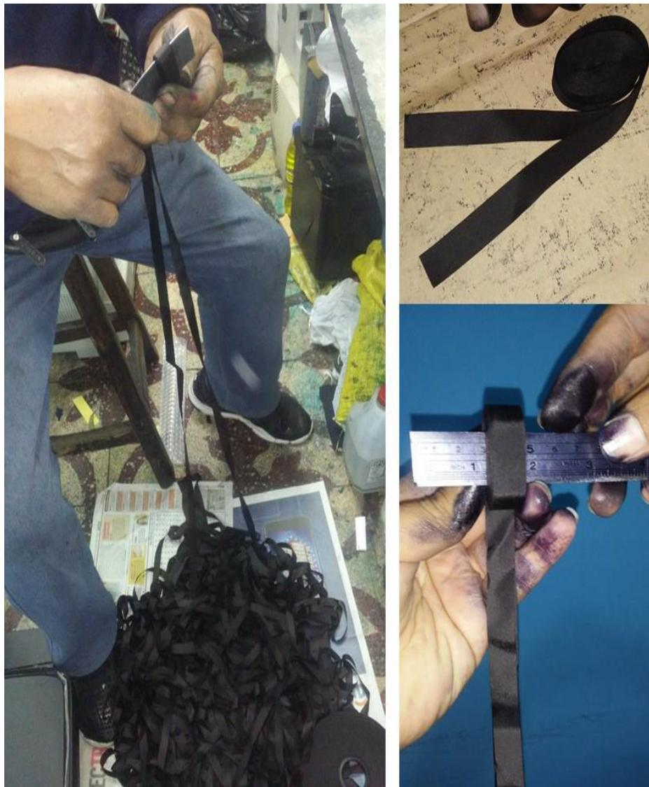
**Figura 8 Medición y rebobinado de la cinta de Nylon**
