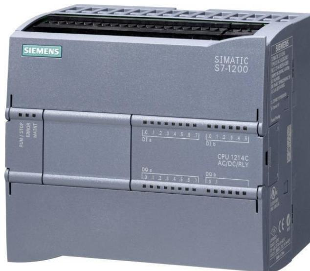
**Figura 9 PLC Siemens**
