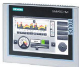
SIMATIC HMI TP700 Comfort, Comfort Panel, mando táctil, pantalla panorámica TFT 7", 16 millones de colores, interfaz PROFINET, interfaz MPI/PROFIBUS DP, memoria de configuración de 12 MB, Windows CE 6.0, configurable a partir de WinCC Comfort V11
