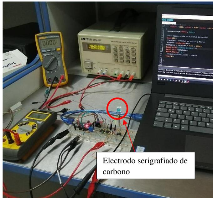
Figura 22: Conexión en Protoboard del circuito de prueba
