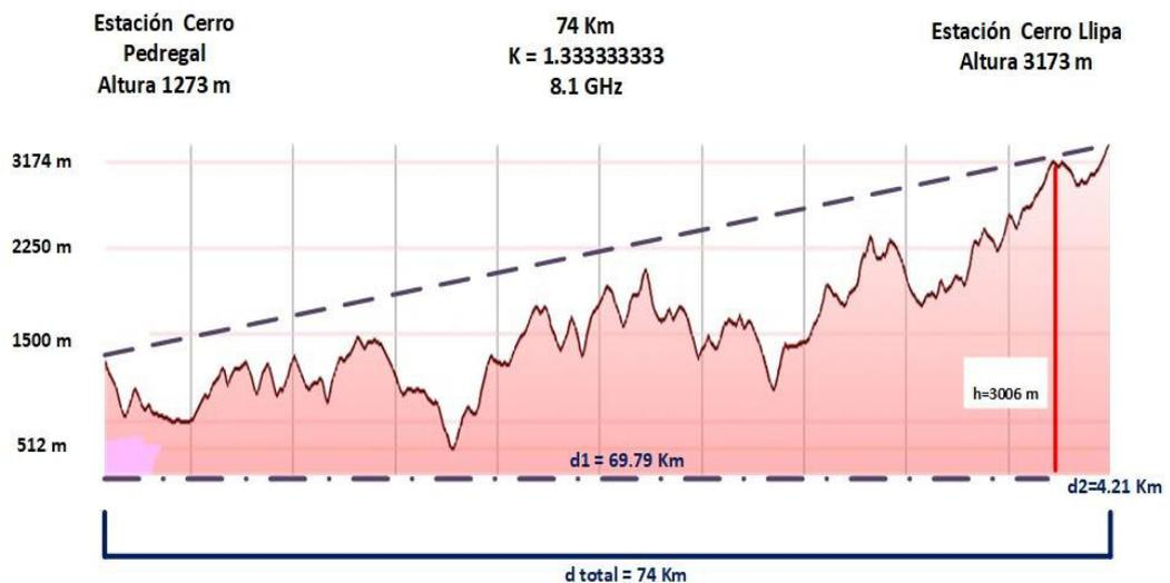
Figura 12. Altura y distancia entre las estaciones repetidoras Cerro Pedregal y Cerro Llipa.
