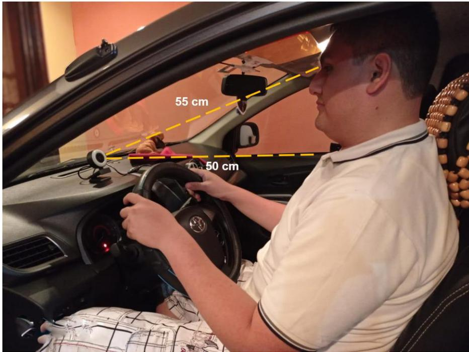
Figura 26: Distancia de la cámara web hacia el conductor de vehículo
