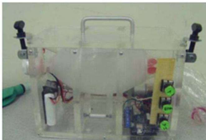
**Figura 4. Prototipo de un ventilador mecánico**
