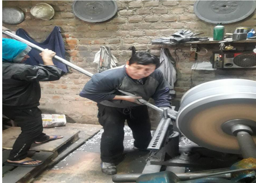
Figura 16: presencia de 2 operarios en el trabajo de repujado
