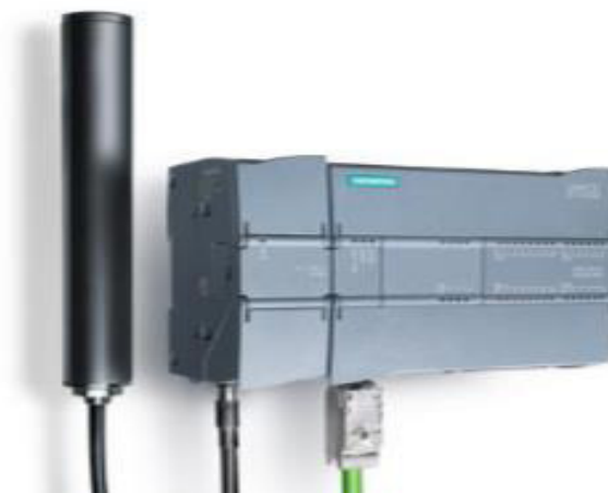
Figura 43: arreglo de la conexión del elemento radiante
