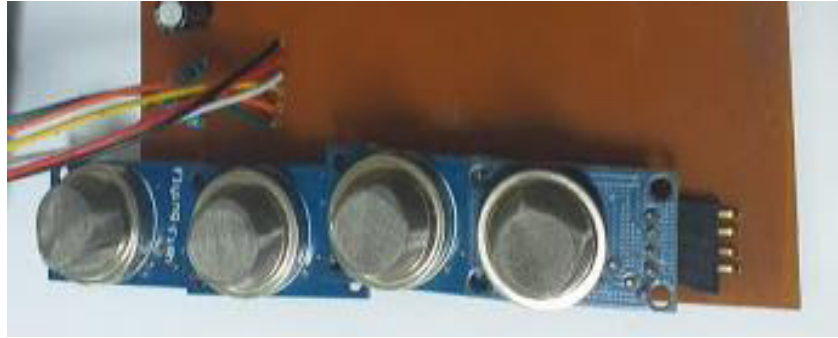
Figura 52. Adaptación de los sensores MQ.
