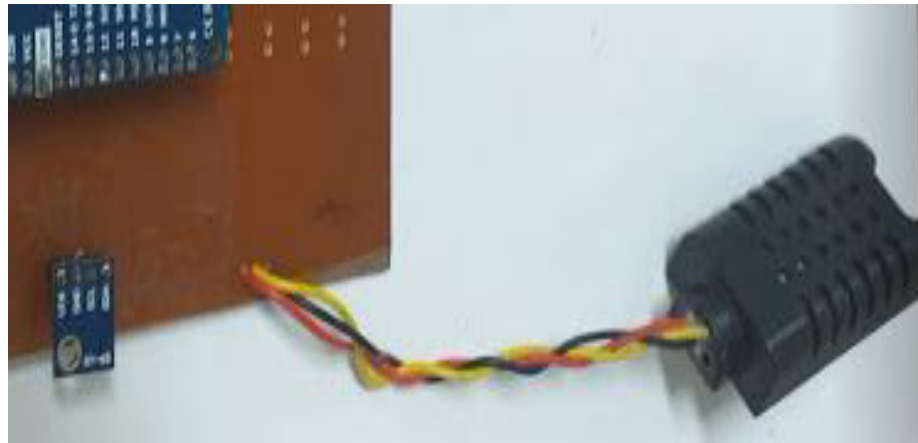
Figura 53. Adaptación de los sensores DHT21.
