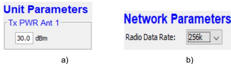
**Figura 50. Configuración de Potencia Tx y Velocidad de Datos**
