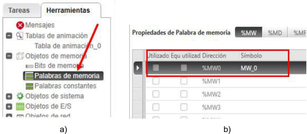
**Figura 29. Configuración de Variable Continua**
