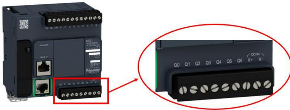
**Figura 20. Salidas Digitales Tipo Transistor**
