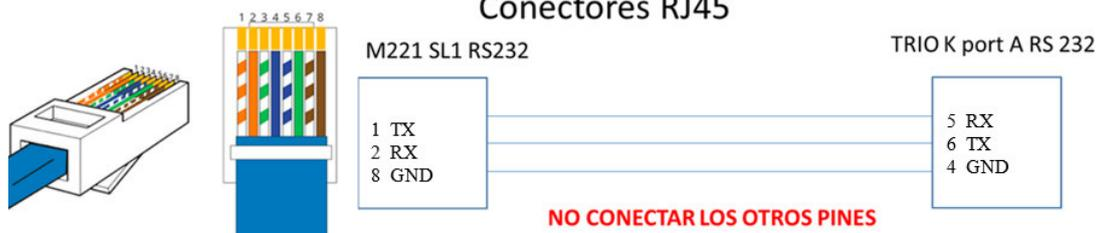
**Figura 54. Armado de Cable RJ45 PLC-Radio**
