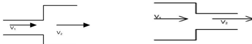
**Fig. 21. Pérdida de carga del agua por el cambio de sección**
