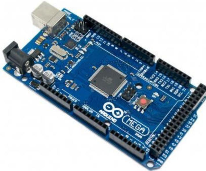
**Figura 2: Placa Arduino Mega2560**
