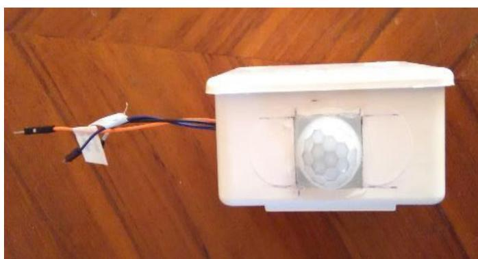
**Figura 29. Montaje del sensor PIR**
