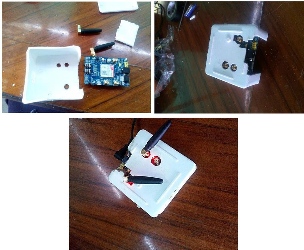
**Figura 35. Montaje del Sim808**
