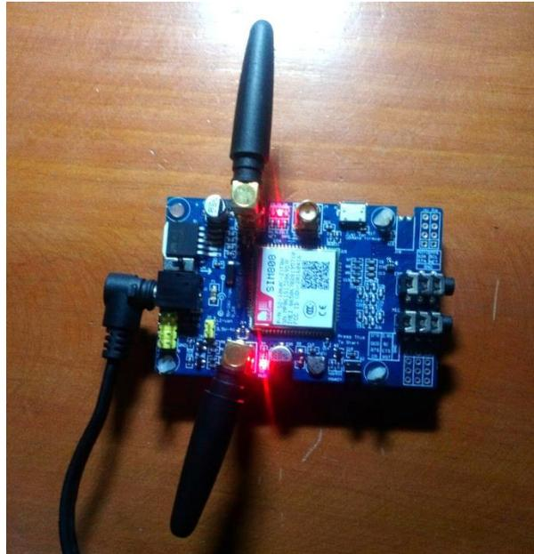
**Figura 32. Sim808 conectado a una red.**
