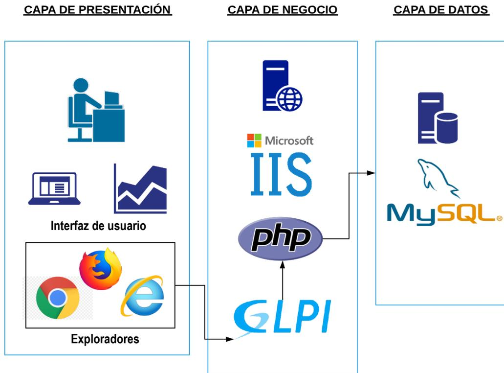
Figura 8: Arquitectura del Sistema GLPI
