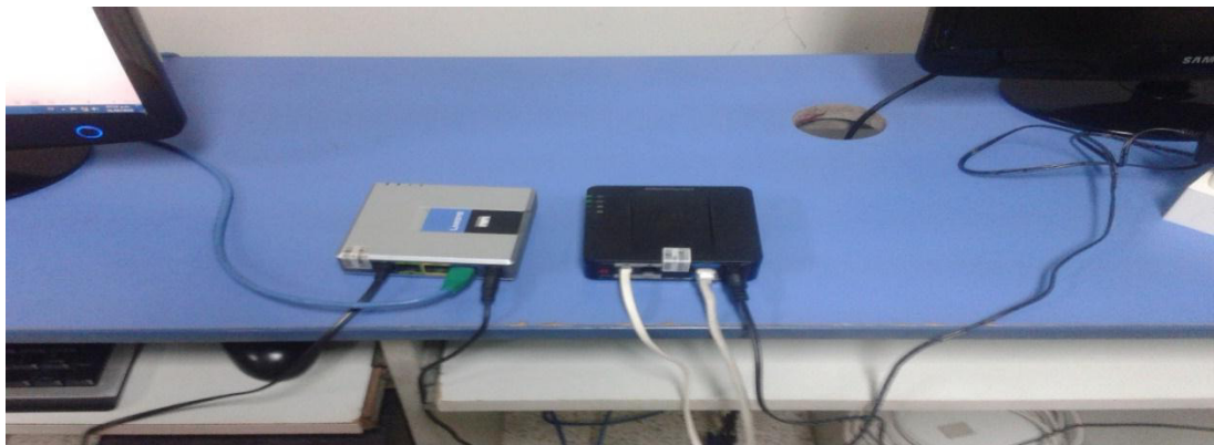
Figura N° 3: en la figura se puede observar la conexión final de los equipos, el Gateway conectado a la red y el adaptador SPA 112 conectado a la red.
