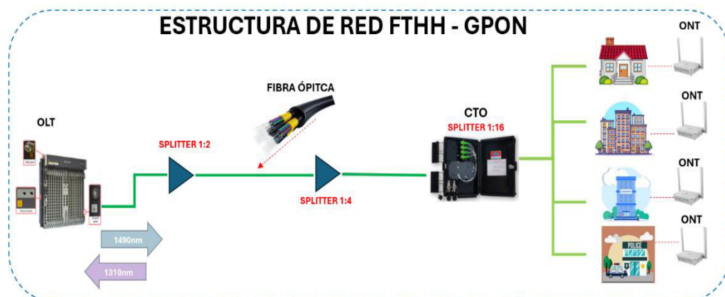
Figura 16 Estructura FTTH con tecnología GPON
