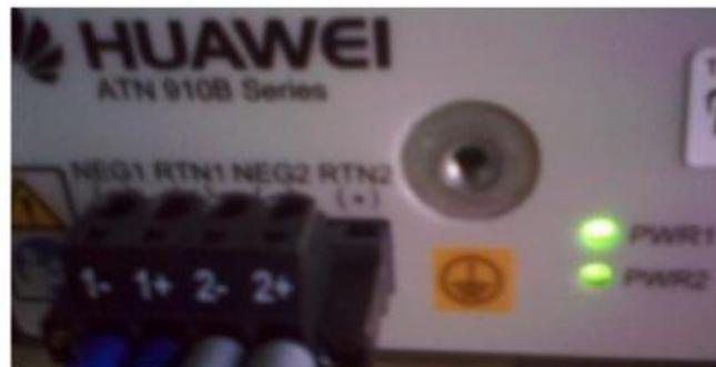
*Figura 1.2 Conexión eléctrica del router Huawei*
