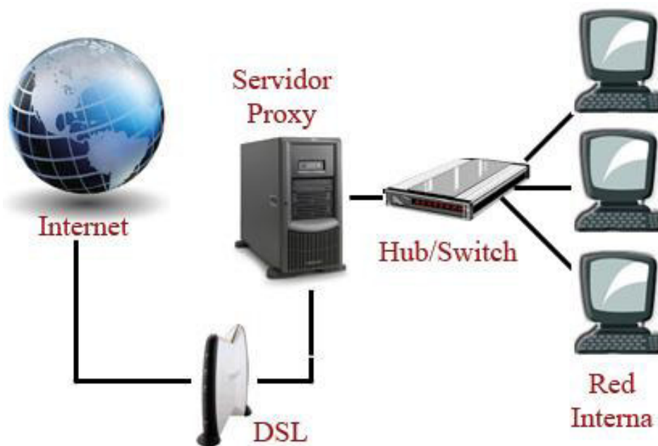
Figura 3.8 Diagrama del funcionamiento de un Servidor Proxy.
