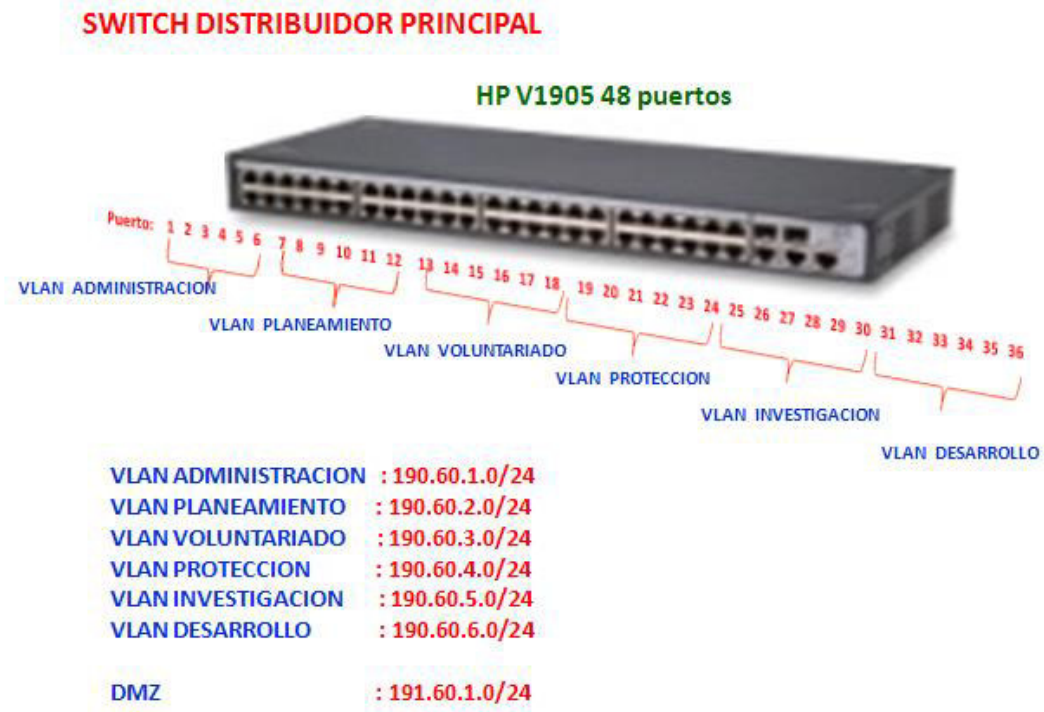
Figura 3.6: Asignación de puertos en el switch
