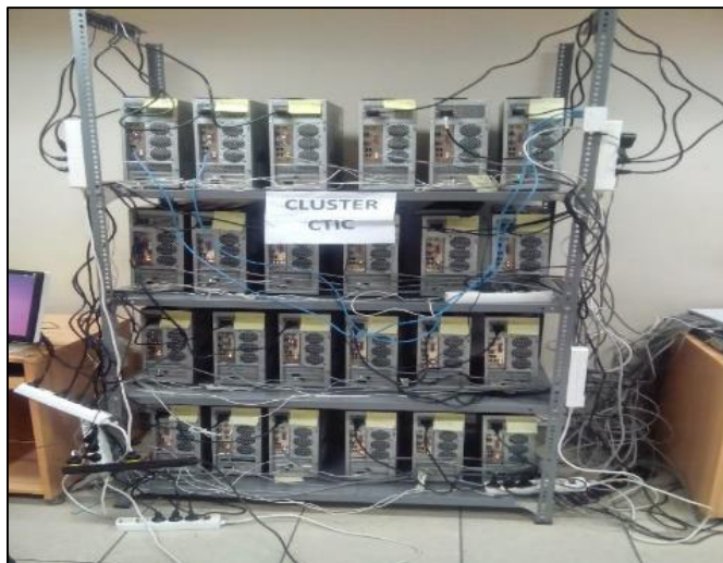
Figura 3. Clúster con ordenadores reciclados
