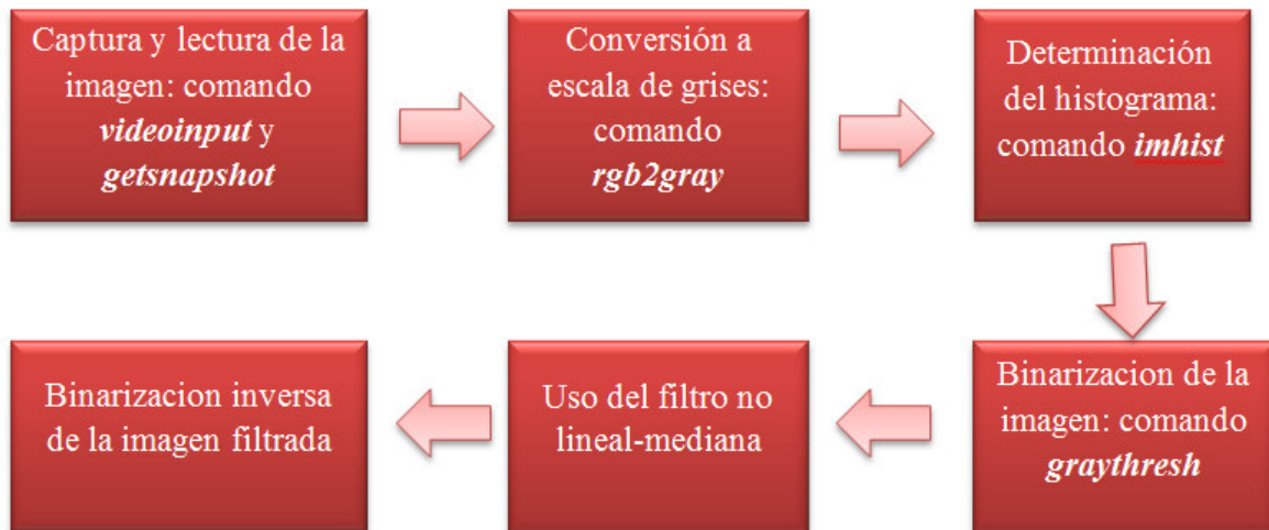
Figura 39: Diagrama de bloques del pre-procesamiento
