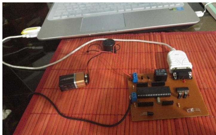
Figura 25: Ensamblaje del sistema de seguridad
