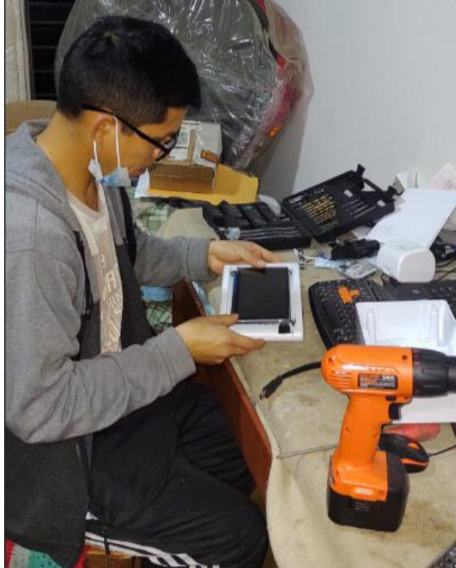
Figura 60: Fijación de la pantalla en la tapa superior
