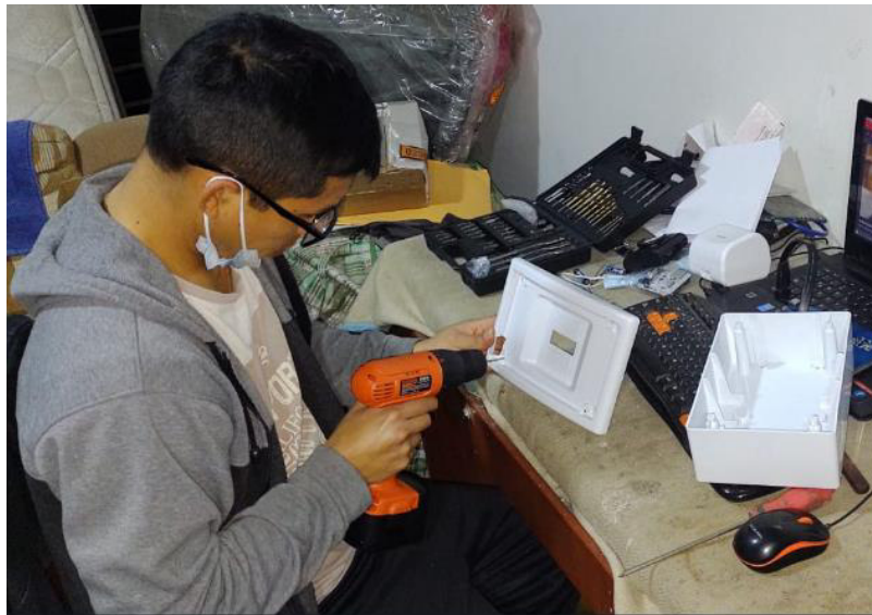
Figura 61: Adecuación de la pantalla en la tapa de caja
