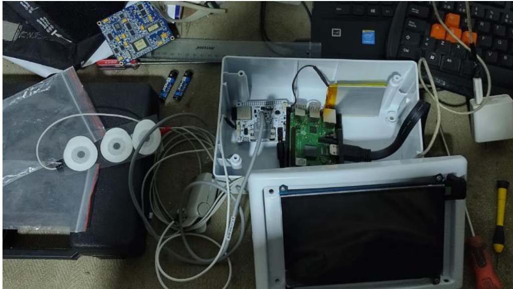
Figura 63: Posición interna de tarjetas electrónicas y componentes en la caja
