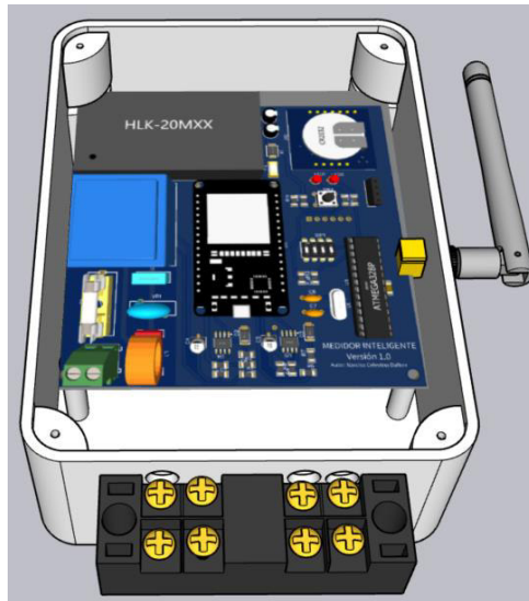
Figura 90. Diseño 3D de la instalación de la PCB en la caja de pase
