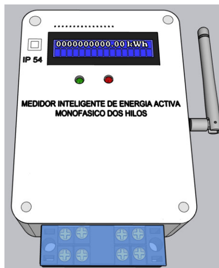
Figura 91. Diseño 3D final del medidor inteligente de consumo eléctrico.
