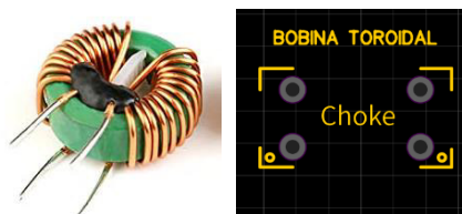
Figura 76. Fotografía y esquemático de la bobina toroidal de nodo común.
