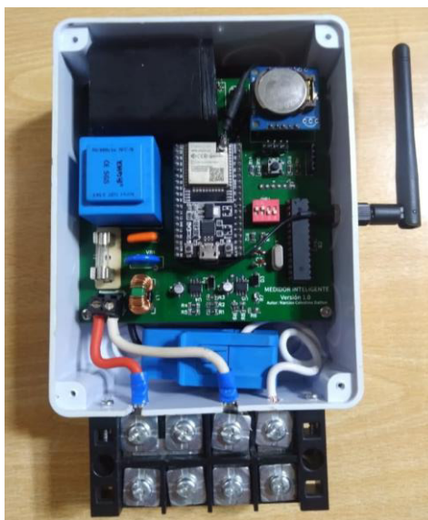
Figura 93. Fotografía del acondicionamiento para el montaje de la PCB, borna de conexión de 60 A y antena 2.4GHz.
