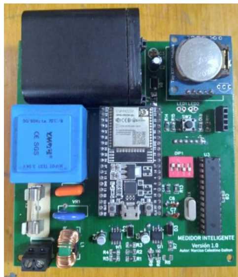
Figura 88. Fotografía final del diseño y fabricación de la PCB Fuente: Propia
