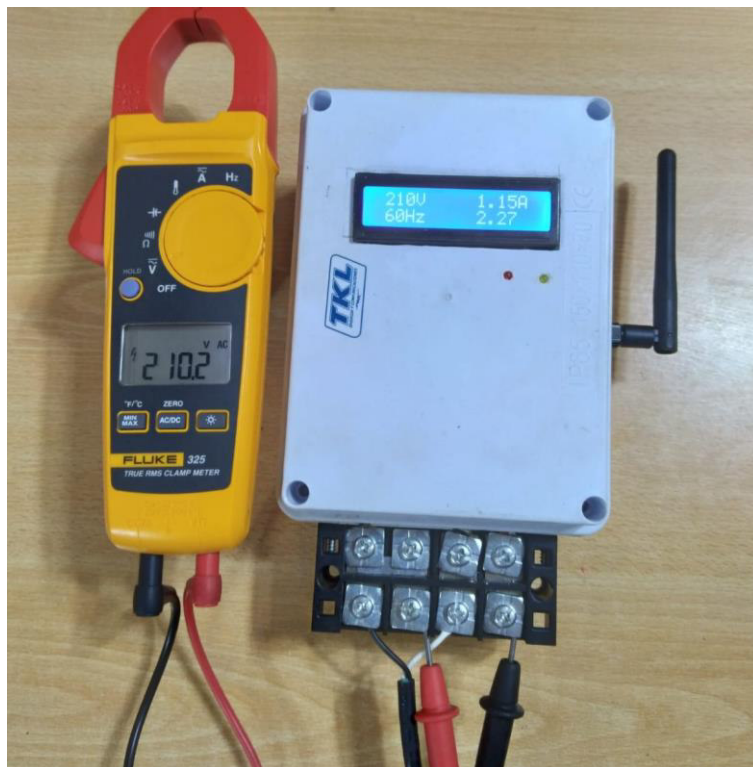
Figura 98. calibración de la señal de tensión
