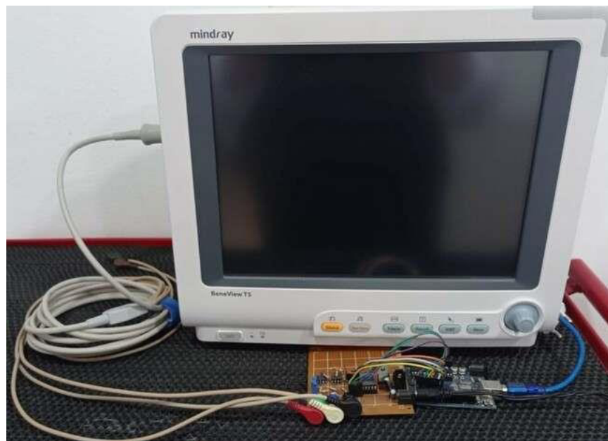
Figura 50: Conexión del simulador al monitor de funciones vitales
