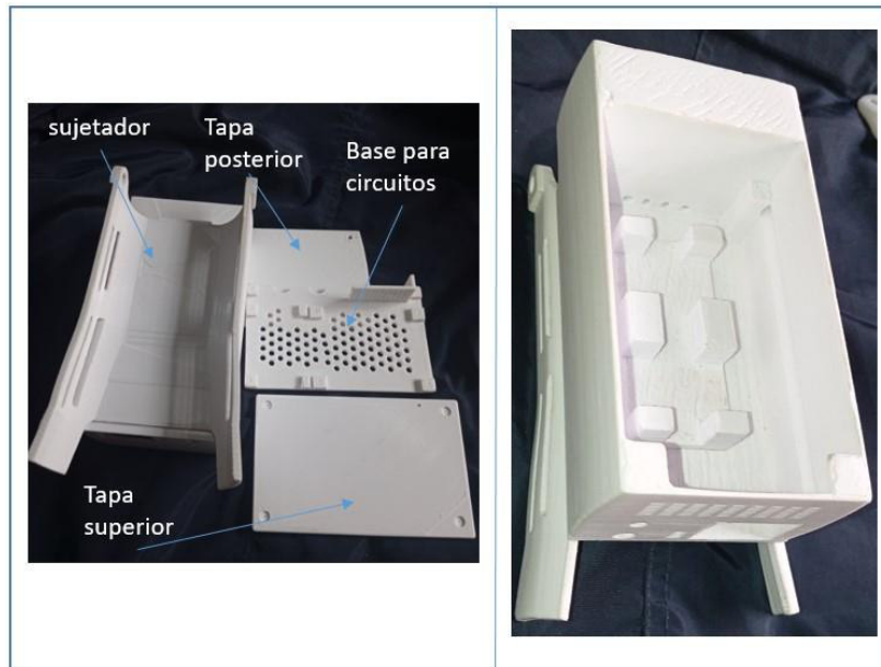
Figura 90: Base de sujeción impreso en plástico ABS
