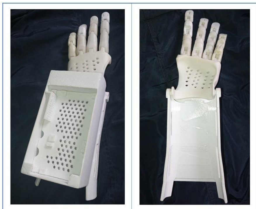
Figura 91: Impresión en plástico ABS del dedo medio
