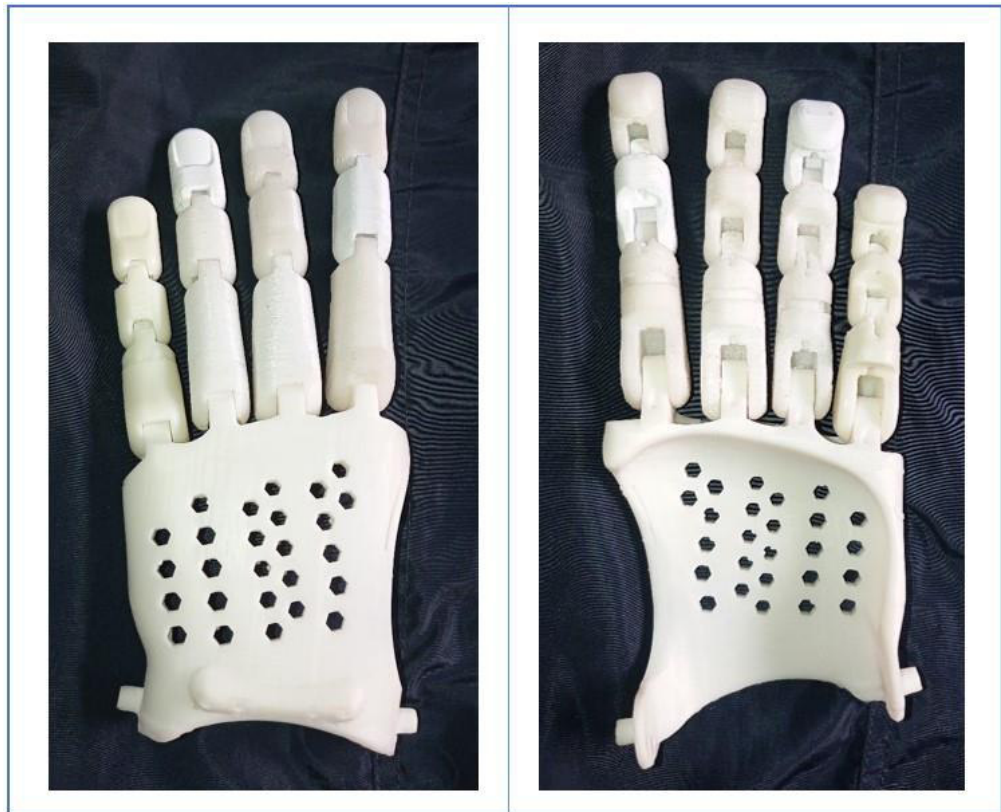
Figura 89: Unión de las piezas del dorso y los dedos de la mano
