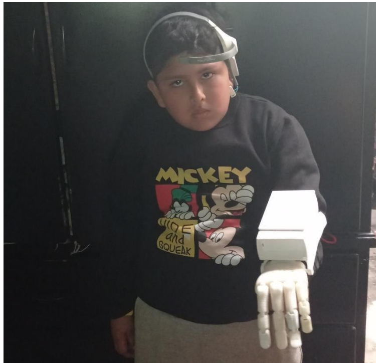
Figura 96: Integración de la prótesis en la persona de prueba
