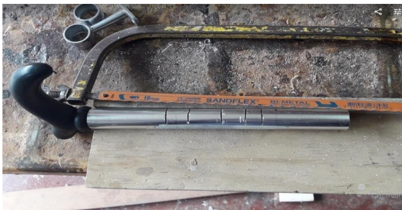
Figura 72: Tubos de aluminio con cortes
