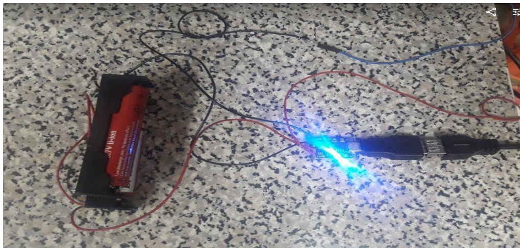
Figura 59: 03962A indicando batería llena Fuente: Elaboración propia
