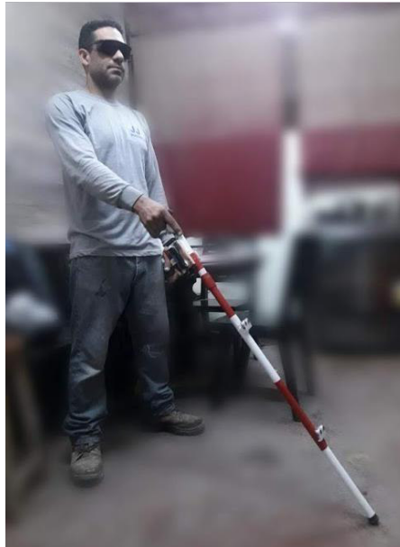
Figura 106: Persona invidente, poniendo en uso el bastón ergonómico con sensor ultrasónico y GPS
