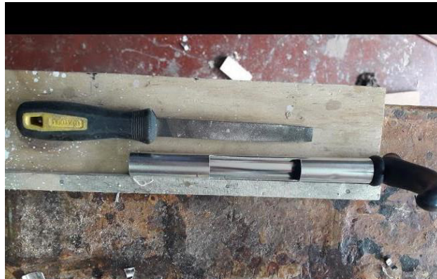
Figura 73: Realización de corte al tubo de aluminio
