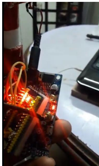
Figura 93: Tarjeta SIM808, encendida correctamente con la STM32F103 conectada Fuente: Elaboración propia
