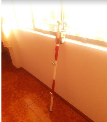
Figura 90: Bastón ergonómico con sensores ultrasónico y GPS, de color blanco y rojo
