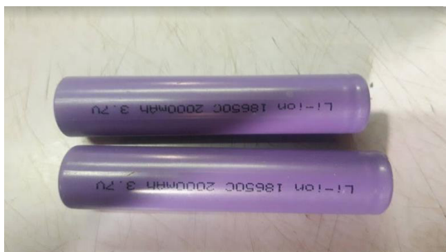
Figura 54: Batería de litio 18650
