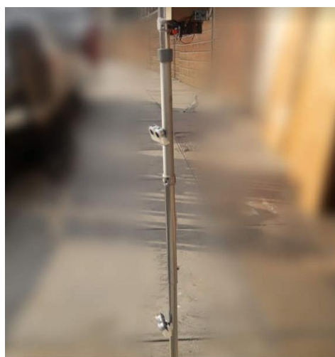
Figura 76: Tubo de aluminio con los dos sensores instalados
