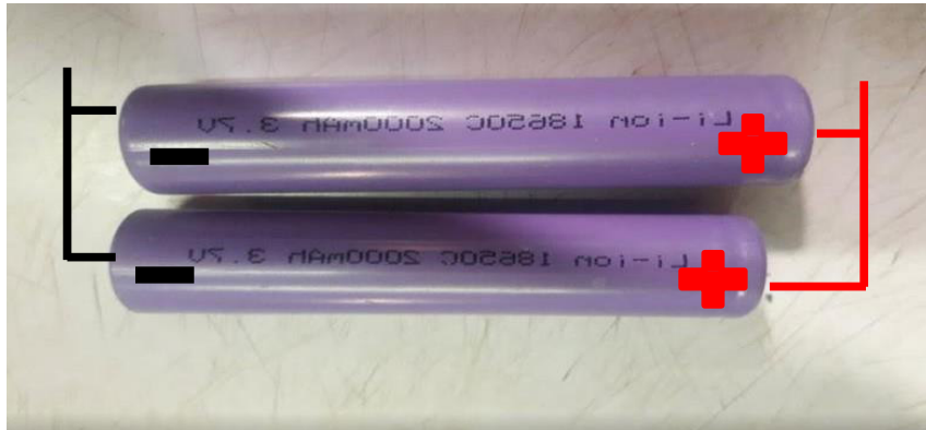
Figura 55: Conexión de la batería de litio 18650
