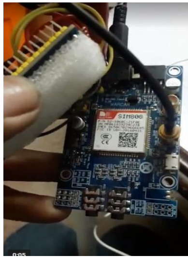
Figura 92: Tarjeta SIM808, conectada y energizada Fuente: Elaboración propia
