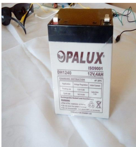
Figura 40: Batería de 12v a 4 Amperios
