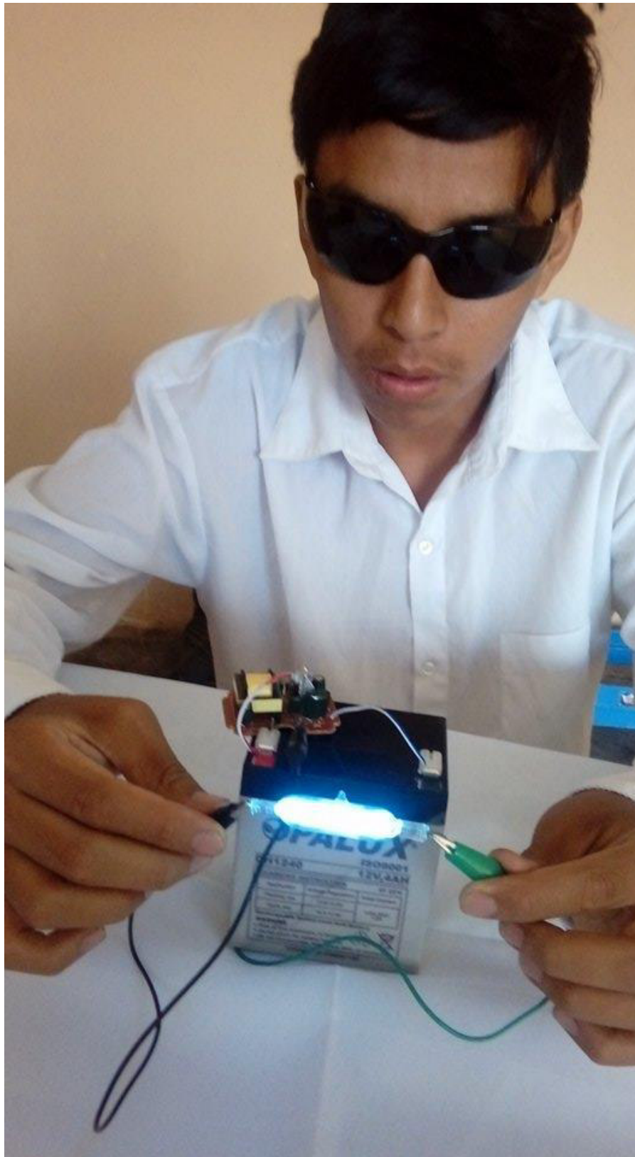
Figura 46: Sistema de radiación ultravioleta germicida
