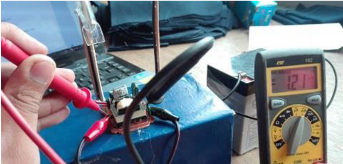
Figura 47: Medición de Intensidad
