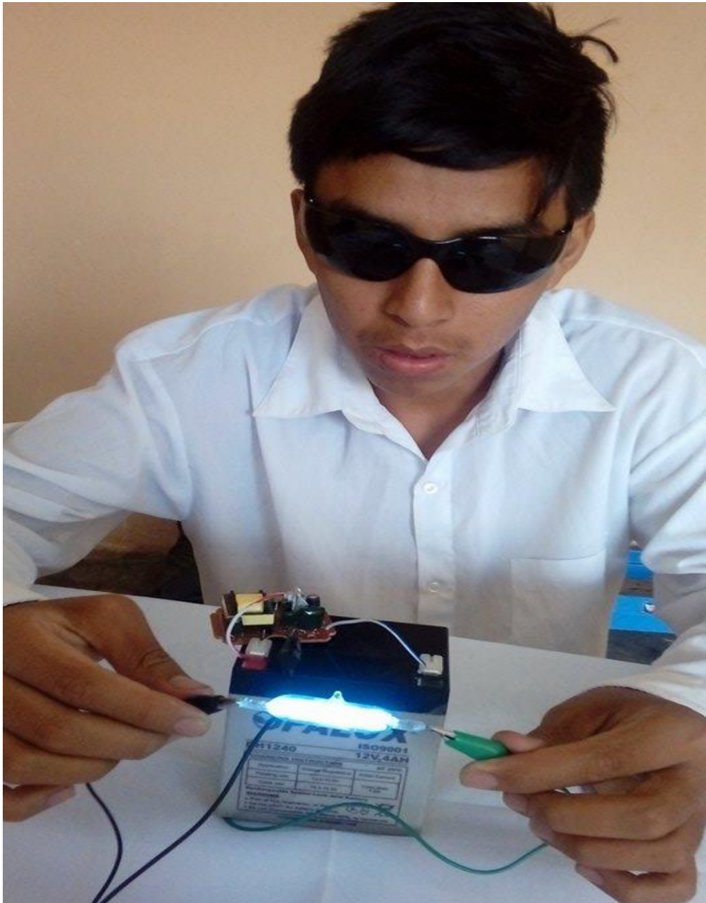
Figura 45: sistema Generando radiación UVC germicida
