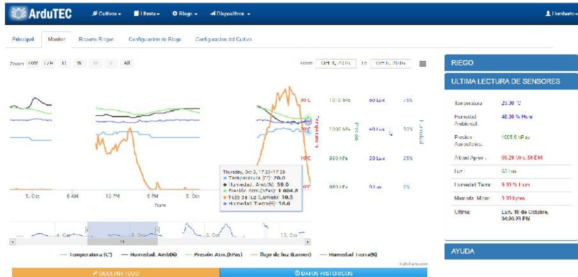
Figura 124. Monitor es donde se visualizan en graficas dinámicas, lo que recolectan los sensores
