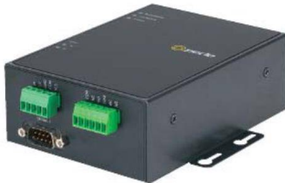
Figura 11. Convertidor Serial/Ethernet IOLAN DS11 (Narvaez, 2008).
