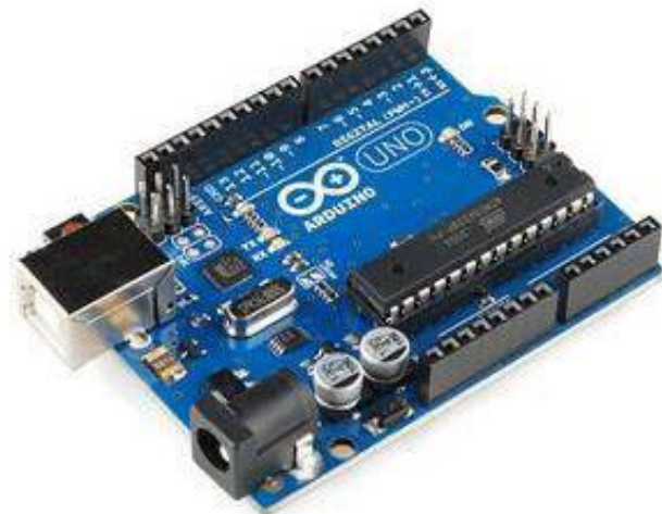
Figura 20. Arduino UNO Rev.3 (arduino.cc, Arduino UNO R3, s.f.)
