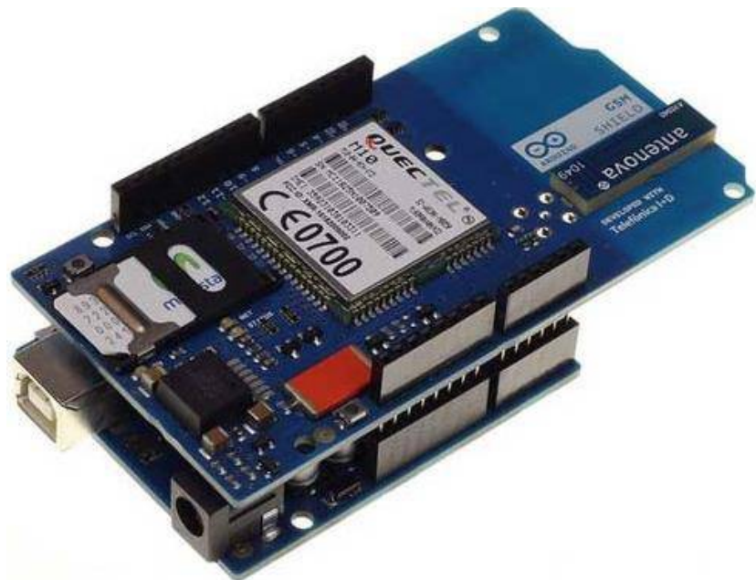
Figura 25. Arduino UNO + Arduino Shield GSM (arduino.cc, Arduino Shield GSM, s.f.)
